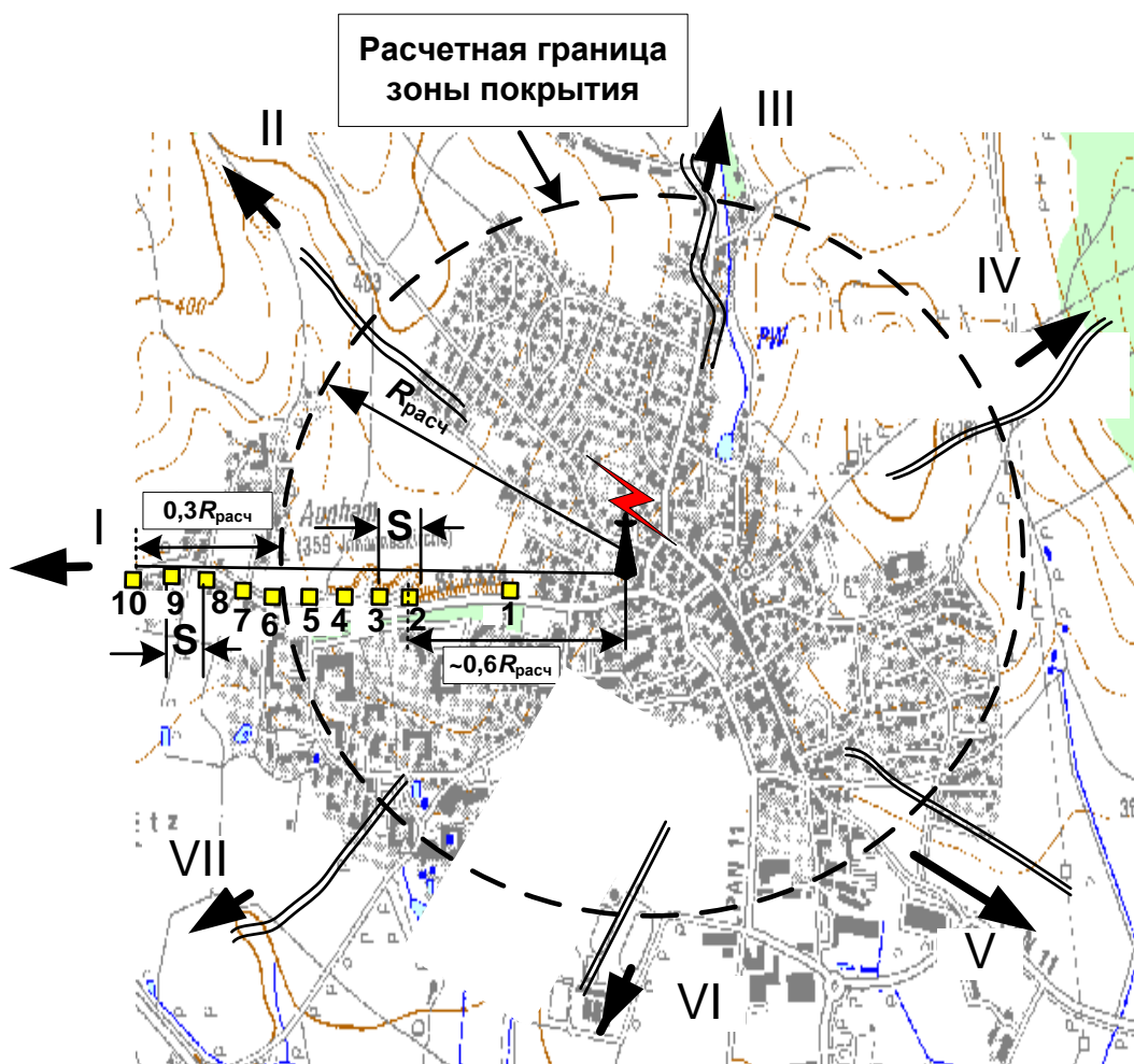
Рисунок 3 – Пример назначения малых зон для определения границы зоны покрытия с последующей корректировкой положения этой границы по результатам измерений.
